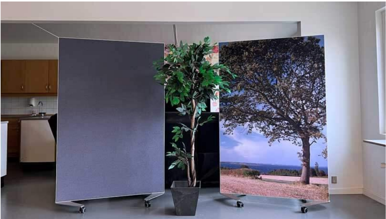
Sonovision skærmvægge i størrelse 120x180 cm med monterede plasthjul. Den ene side er beklædt med kanvasstof i brandklasse B. Den anden side med printet lærred af polypropylenvæv ligeledes i brandklasse B..
